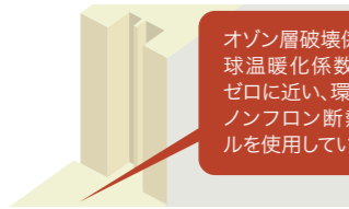
芯材の発泡工程でHFOを使用
