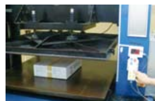
カートンの圧縮強度試験
